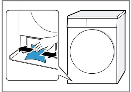
7. Introducir la pieza de inserción en posición horizontal hasta que la lengüeta encaje.
