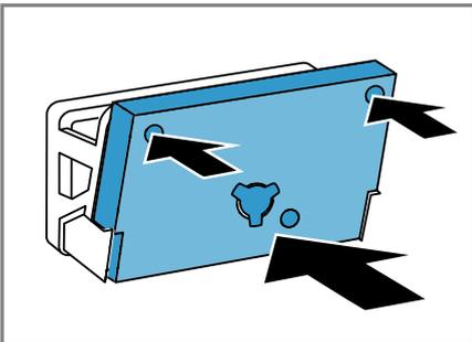
Asegurarse de no deformar, dañar o colocar al revés la manta filtro
