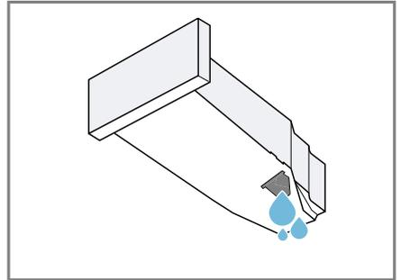
Asegurarse de insertar el recipiente de agua condensada antes de la puesta en marcha del aparato.
