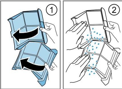
Eliminar las pelusas con la basura doméstica para evitar la contaminación del agua residual con microplásticos.
