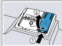
2. Poner abriillantador hasta la marca de llenado máximo.
