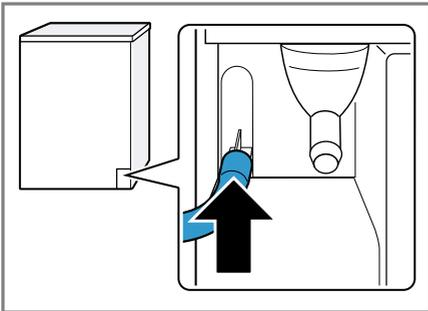
3. Den Wasserabflussschlauch bis zum Anschlag auf den Stutzen schieben.
