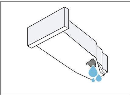
Prüfen Sie regelmäßig den Filter des Kondenswasserbehälters und reinigen Sie einen verunreinigten Filter. → *Seite 36*
