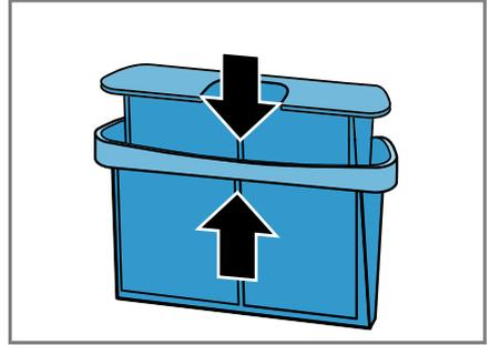
8. Das zweiteilige Flusensieb einsetzen.
