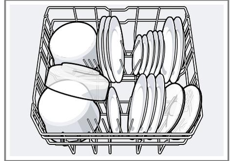
Los platos grandes hasta un diámetro de 31/34 cm<sup>1</sup> se pueden colocar como se muestra en la ilustración.
