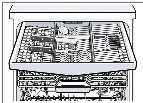
Colocar los cubiertos con el lado puntiagudo o cortante hacia abajo. A fin de disponer de más espacio para colocar cubiertos de mayor tamaño, es posible ampliar el cajón para cubiertos.<sup>1</sup>
