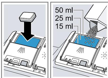
Si utiliza pastillas de detergente, basta una pastilla. Colocar las pastillas en posición transversal.
