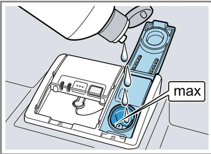
3. Si el abrillantador rebosa, eliminarlo de la cuba. El abrillantador derramado puede provocar una formación excesiva de espuma durante el ciclo de lavado.
