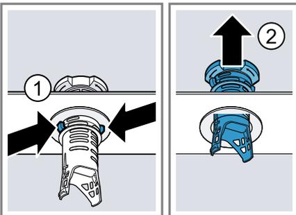
5. Limpiar los elementos filtrantes bajo el chorro de agua del grifo. Limpiar con cuidado el borde de suciedad entre el filtro grueso y el filtro fino.
