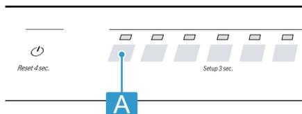
Cuando el LED A no está encendido, la conexión de red inalámbrica está desactivada.
