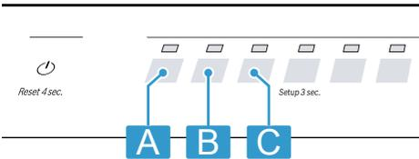
**Nota:** Ajuste el aparato al grado de dureza del agua determinado.
