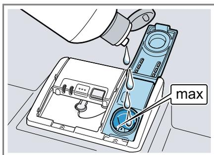
3. Si el abrillantador rebosa, eliminarlo de la cuba. El abrillantador derramado puede provocar una formación excesiva
