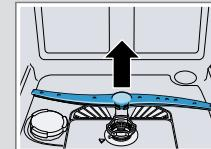
3. Pod tekočo vodo preverite, ali so izstopne šobe brizgalk zamšene in odstranite tujke.
