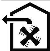
Die Luft darf nicht in einen Kamin abgeleitet werden, der für Abgase von Geräten verwendet wird, die Gas oder andere Brennstoffe verbrennen (dies gilt nicht für Umluftgeräte).
