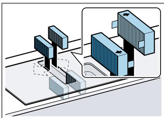
5. Den Fettfilter in das Gerät einsetzen.
