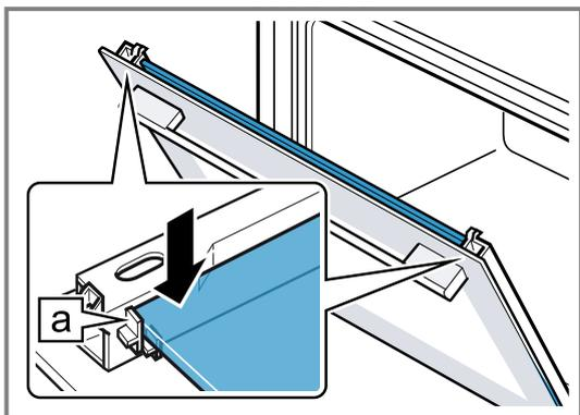
5. Die Gerätetür öffnen und Türdichtung einhängen.
