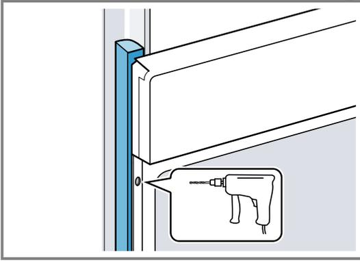
4. Das Gerät mit adäquater Schraube befestigen.
