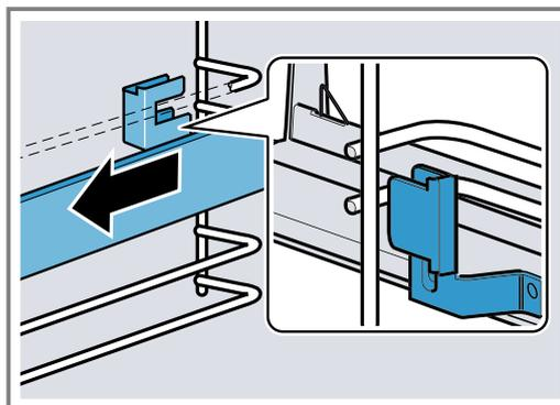
4. Die Auszugsschiene entfernen.
