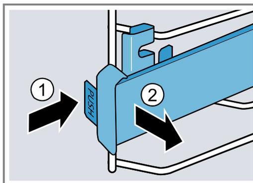
3. Die Schiene nach vorn ziehen, bis die Halterung hinten ausgehängt ist.
