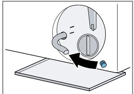
9. Sujetar el tubo de drenaje a la sujeción.
