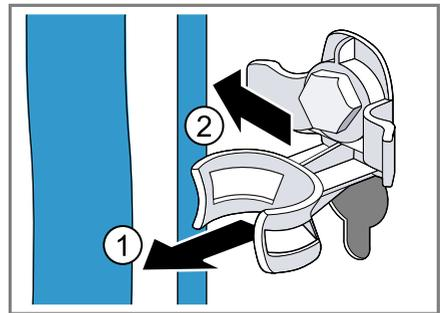
2. Aflojar ① y retirar ② todos los tornillos de los cuatro seguros de
