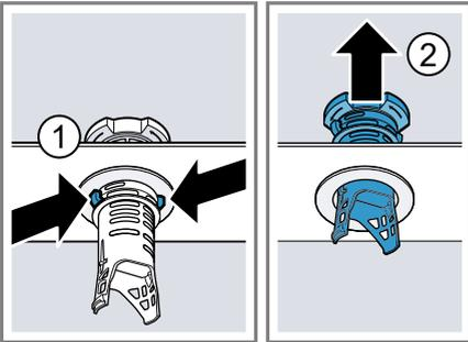
5. Unter fließendem Wasser die Siebelemente reinigen.
