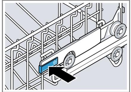
4. Den Geschirrkorb auf die passende Stufe gleichmäßig absenken oder anheben.
