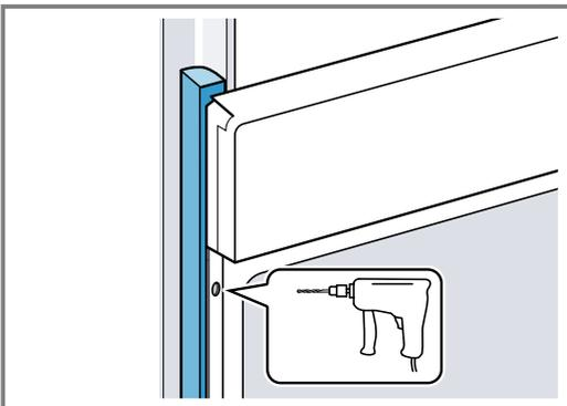
4. Das Gerät mit adäquater Schraube befestigen.
