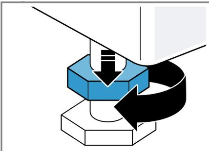
2. Um das Gerät auszurichten, die Gerätefüße drehen. Die Ausrich-
