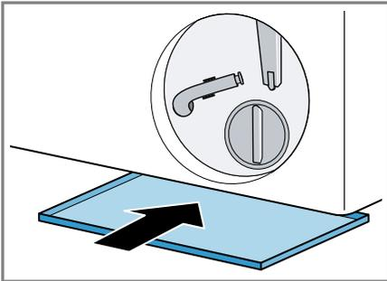
6. Den Entleerungsschlauch aus der Halterung nehmen.
