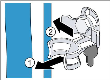
2. Alle Schrauben der 4 Transportsicherungen mit einem Schraubenschlüssel der Schlüsselweite 13 lösen ① und entfernen ②.
