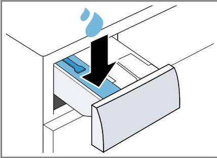
6. Pulvervollwaschmittel mit Sauerstoffbleiche in die Kammer für manuelle Dosierung einfüllen.
