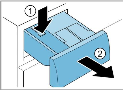
4. Die Pumpeneinheit entfernen.
