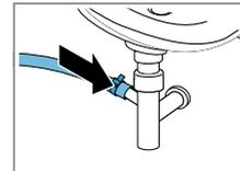
Die Anschlussstelle mit einer Schlauchschelle (24-40 mm) sichern.
