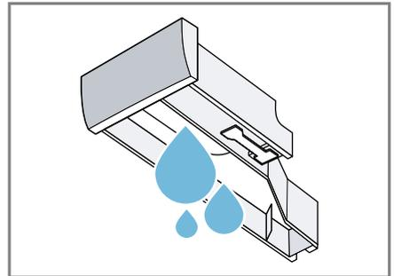
7. Die Pumpeneinheit mit einem feuchten Tuch reinigen.
