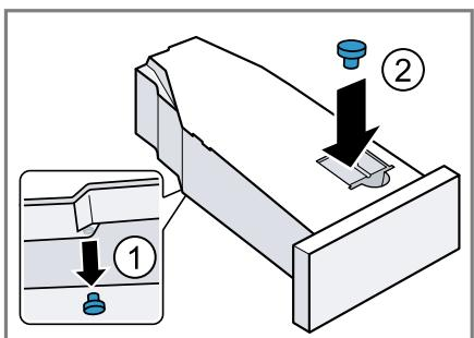
6. Mettez en place le réservoir d'eau de condensation.
