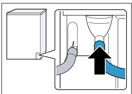
4. Vider le réservoir d'eau de condensation.
