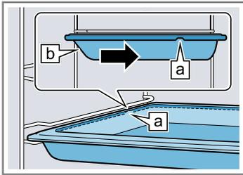
Posez l'accessoire sur les rails télescopiques insérés.
