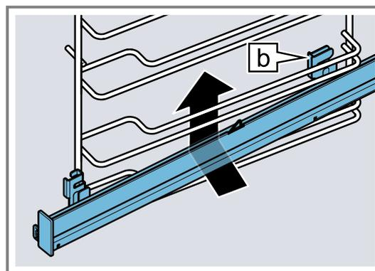
2. Guidez le rail dans le sens de la longueur vers les barres de guidage à l'arrière et poussez les deux supports à chaque fois sur la barre inférieure. Saisissez la barre verticale avec le support arrière ⑤.
