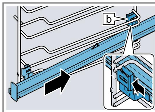
3. Maintenez enfoncé **PUSH** ① et faites pivoter le rail télescopique vers l'intérieur ②, jusqu'à ce que le support ③ soit accroché dans la barre inférieure.
