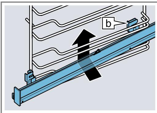
2. Die Schiene längs zu den Führungsstäben nach hinten führen und beide Halterungen jeweils auf den unteren Stab aufschieben. Dabei mit der hinteren Halterung **b** den senkrechten Stab umgreifen.
