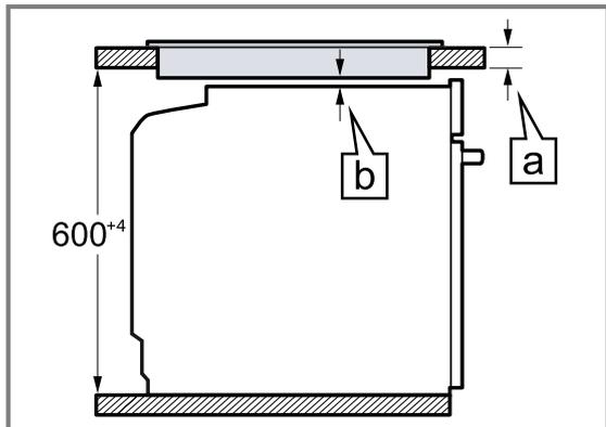
En raison de la distance minimale nécessaire  $\text{[b]}$  l'épaisseur minimale du plan de travail qui en découle est  $\text{[a]}$ .
