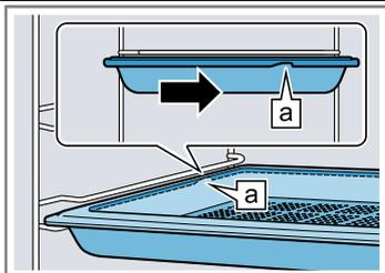
Posez l'accessoire sur les rails télescopiques insérés.
