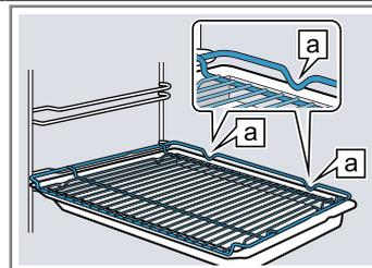
**Grille combinée** Introduisez la grille avec la courbure
