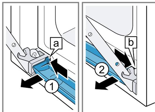
3. Die Kondensatwanne leicht nach vorne kippen bis sich die unteren Haltehaken lösen.
