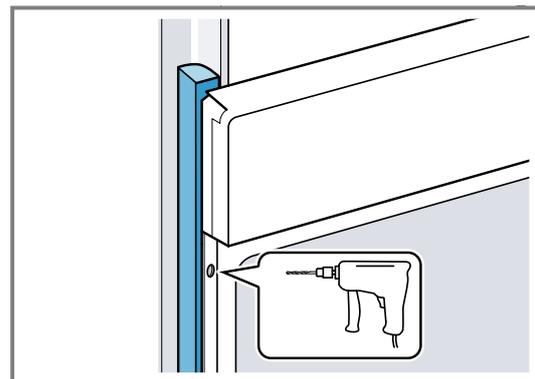
4. Das Gerät mit adäquater Schraube befestigen.
