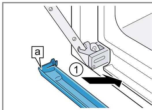
2. Die Haken **a** der Kondensatwanne links und rechts in die Spalte einrasten ①.
