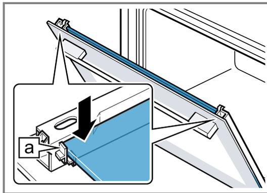
5. Die Gerätetür öffnen und Türdichtung einhängen.
