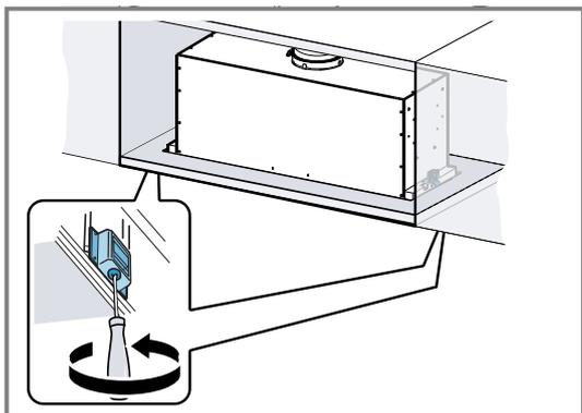
3. Atornillar los dos tornillos delanteros y seleccionar el orificio de forma que la superficie del aparato quede enrasada con el hueco de encastre.
