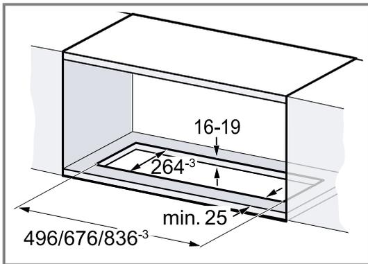
2. Hacer el corte para el tubo de salida de aire encima del mueble empotrado o detrás de los muebles empotrados por encima del aparato.
