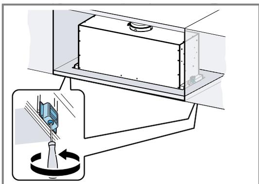
3. Die vorderen beiden Schrauben so einschrauben und die Bohrung so wählen, dass die Oberfläche des Geräts bündig am Einbaumöbel anliegt.
