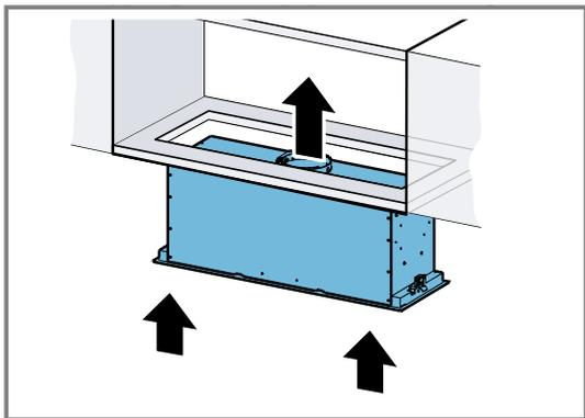
2. Die beiden Fixierungsschrauben abwechselnd links und rechts anziehen. Geeignetes Werkzeug verwenden, um die Oberfläche nicht zu beschädigen.
