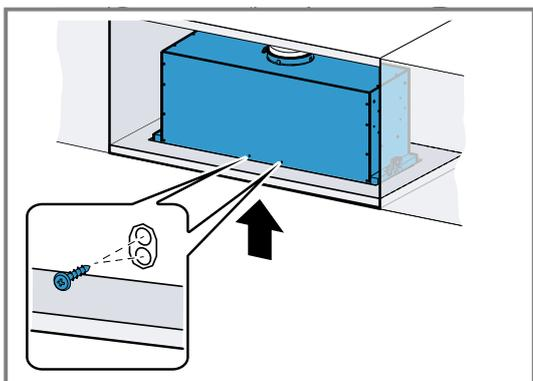
4. Die beiden Schraubenabdeckungen einsetzen.
