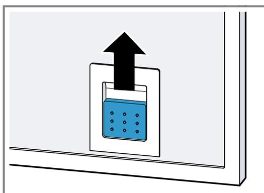
3. Retirar los filtros antigrasa de las sujeciones. Sujetar los filtros antigrasa en posición horizontal para evitar que la grasa gotee.
