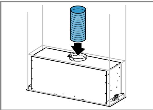
2. Establecer la conexión con la abertura de salida de aire.
