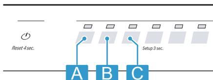
Cuando el LED A está encendido, la función está desactivada de manera permanente.
