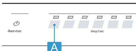
Cuando el LED A no está encendido, la conexión de red inalámbrica está desactivada.
