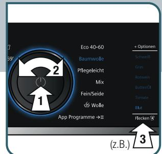
Gerät einschalten, Programmähnler auf das gewünschte Programm drehen. Programm gegebenenfalls wie folgt anpassen:
