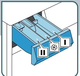
Sich vor dem Einfüllen der Waschmittel über die optimale Dosierung informieren. Für Flüssigwaschmittel die Dosierhilfe herunterklappen.
