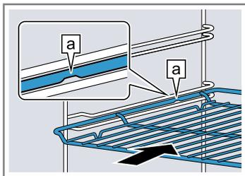
Blech Das Blech mit der Abschrägung [a] zur Gerätetür einschieben. z. B. Universalpfanne
