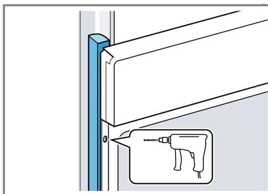
4. Das Gerät mit adäquater Schraube befestigen.
