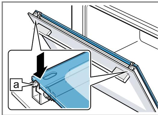
8. Die Türabdeckung aufsetzen
