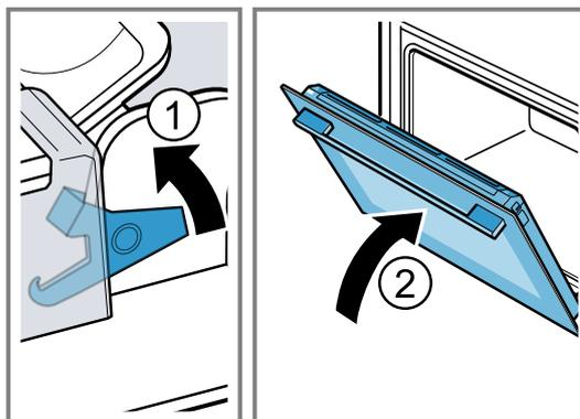
4. Die Türabdeckung links und rechts von außen drücken ①, bis sie ausrastet.
