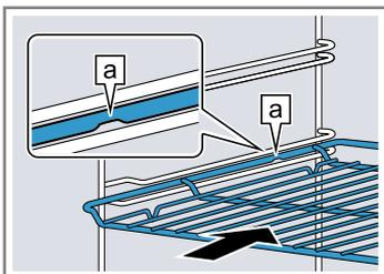
Blech Das Blech mit der Abschrägung
