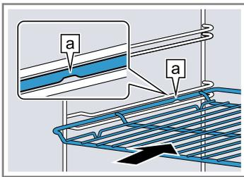
**Blech** Das Blech mit der Abschrägung
