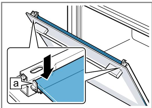
5. Die Gerätetür öffnen und Türdichtung einhängen.
