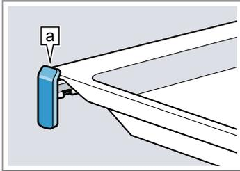
**Nota:** Totalmente extraídas, as calhas extensíveis engatam. Empurre as calhas extensíveis para o interior do aparelho exercendo alguma pressão.
