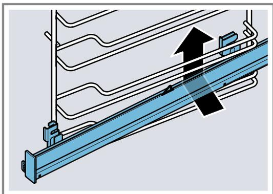
2. Conduza a calha longitudinalmente às hastes guia para trás e insira os dois suportes respetivamente na haste inferior. Para o efeito, com o suporte traseiro
