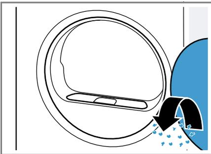
3. Das zweiteilige Flusensieb entfernen.
