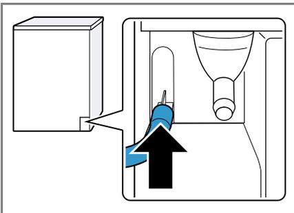
3. Den Wasserablaufschlauch bis zum Anschlag auf den Stutzen schieben.
