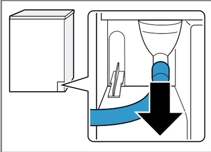
Der Kondenswasserschlauch ist werkseitig am Stutzen angeschlossen.
