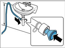
Die Anschlussstelle mit einer Schlauchschelle (12-22 mm) sichern. Den Wasserabflussschlauch mit einer Schlauchführung in minimal 80 cm und maximal 100 cm Höhe befestigen.
