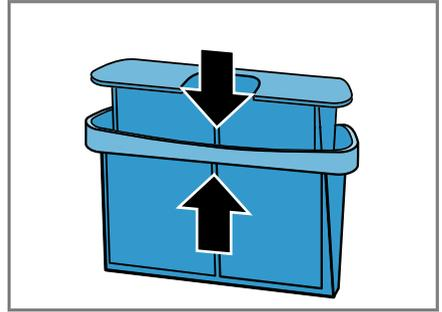
10. Das zweiteilige Flusensieb einsetzen.
