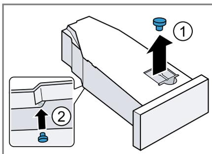
2. Limpiar el filtro del depósito de agua condensada.
