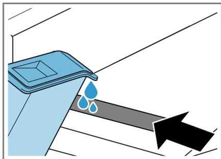
Respetar la marca de llenado del depósito de agua que se encuentra junto a la abertura delantera. Si no se apaga ☒ en el display, nivelar correctamente el aparato.
