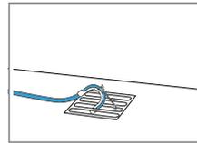
Deslizar la manguera de salida de agua completamente por el racor en codo y fijarla con el material de fijación. Fijar el racor en codo en el canal.
