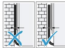
No aprisionar las mangueras ni el cable de alimentación de red entre la pared y el aparato.
