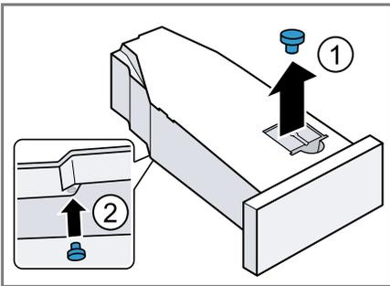
2. Den Filter im Kondenswasserbehälter reinigen.
