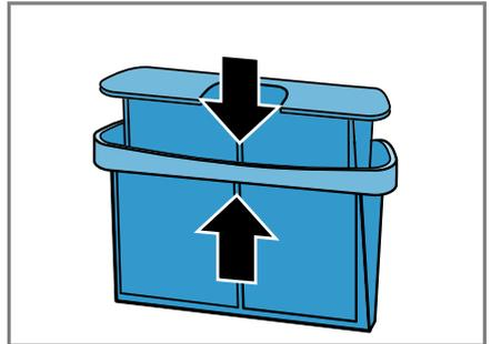
10. Das zweiteilige Flusensieb einsetzen.
