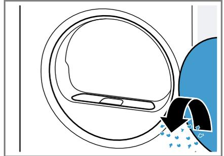
3. Das zweiteilige Flusensieb entfernen.
