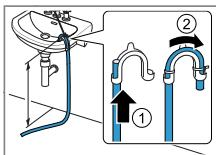
Poussez le tuyau d'évacuation d'eau complètement à travers le coude et fixez-le avec le matériel de fixation. Fixez le coude à une hauteur de 100 cm maximum.
