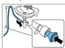
Fixez le point de raccordement avec un collier de serrage (12-22 mm).
