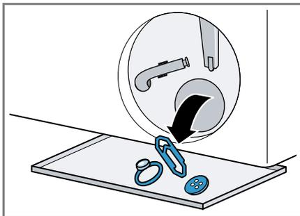
2. Assegure-se de que a roda de pás da bomba de escoamento se deixa girar.
