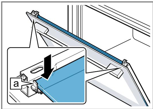
5. Die Gerätetür öffnen und Türdichtung einhängen.
