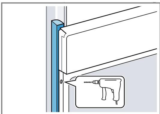
4. Das Gerät mit adäquater Schraube befestigen.
