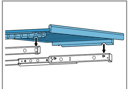
2. Die Flaschenablage mit den Auszugsschienen bis zum Anschlag ins Gerät schieben.
