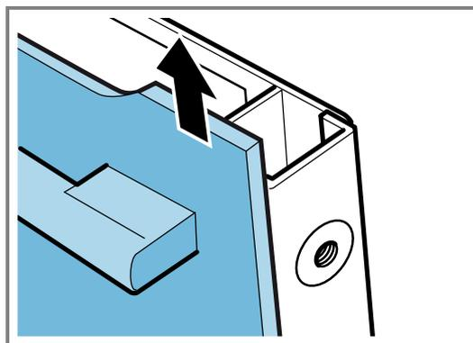
4. Colocar el cristal de la puerta con la maneta hacia abajo sobre una superficie plana.
