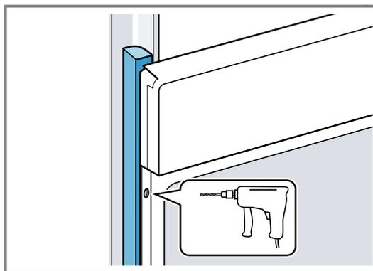
4. Fijar el aparato con los tornillos adecuados.
