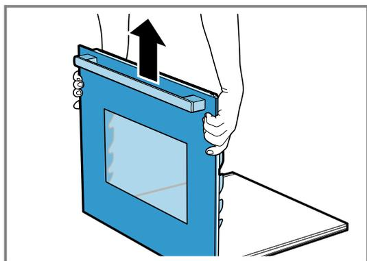
3. Colocar con cuidado la puerta del aparato sobre una superficie plana. En la parte inferior de la puerta hay componentes delicados.
