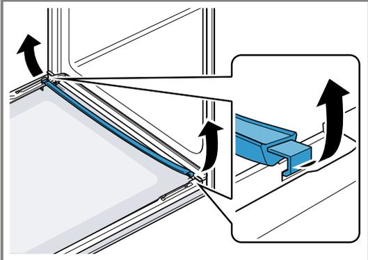
8. Extraer el cristal intermedio y depositarlo con cuidado sobre una superficie plana.
