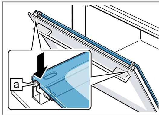
8. Colocar la cubierta de la puerta ① y presionar hasta que se oiga que ha encajado.
