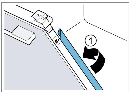
4. Introducir el cristal interior abajo en la sujeción ① y colocarlo en la parte superior.
