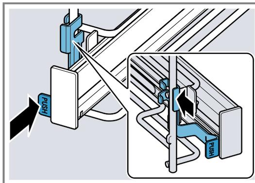
2. Mantener pulsado **PUSH** ① e inclinar el riel hacia fuera ② hasta que la sujeción delantera a se desenganche.
