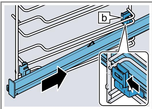
3. Mantener pulsado **PUSH** **1** e inclinar el riel de extracción hacia dentro **2** hasta que la sujeción **a** se enganche en la varilla inferior.
