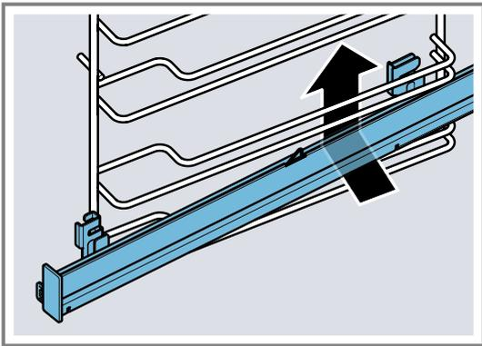
2. Guiar el riel a lo largo de las varillas de guía hacia atrás y deslizar las dos sujeciones en la varilla inferior. Al hacerlo, agarrar la varilla vertical con la sujeción trasera **b**.
