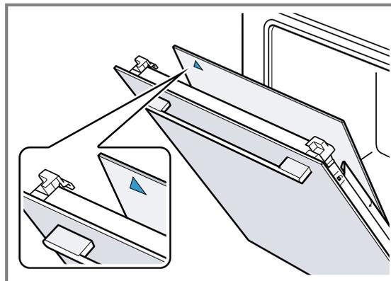
1. Introducir el primer cristal intermedio en la sujeción inferior ① y colocarlo en la parte superior.
