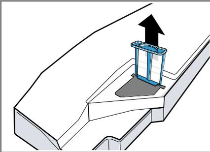
3. Den Filter mit fließendem, warmen Wasser oder in der Geschirrspülmaschine reinigen.
