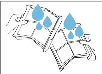
9. Die beiden Flusensiebe schließen und zusammensetzen.
