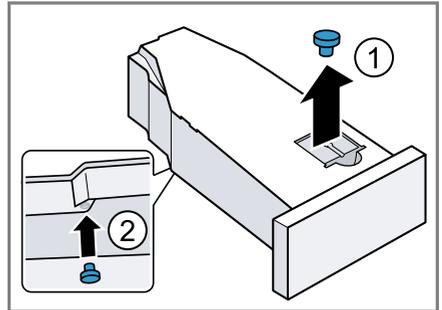
2. Den Filter im Kondenswasserbehälter reinigen.
