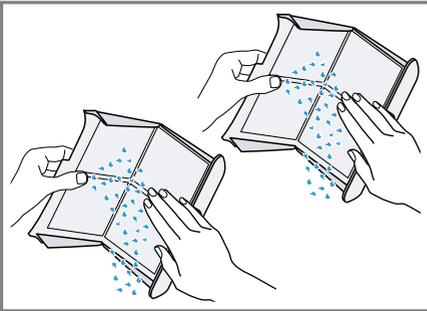
8. Die beiden Flusensiebe gründlich mit fließendem, warmem Wasser reinigen und abtrocknen.
