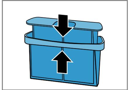
10. Das zweiteilige Flusensieb einsetzen.
