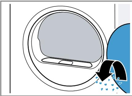
3. Das zweiteilige Flusensieb entfernen.
