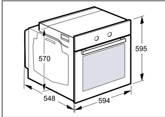
**18.3 Einbau unter einer Arbeitsplatte**
