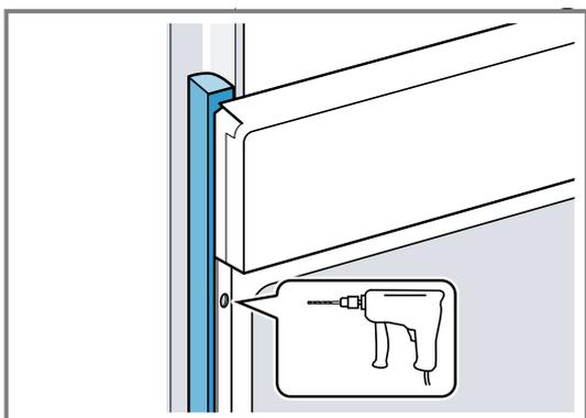
4. Das Gerät mit adäquater Schraube befestigen.
