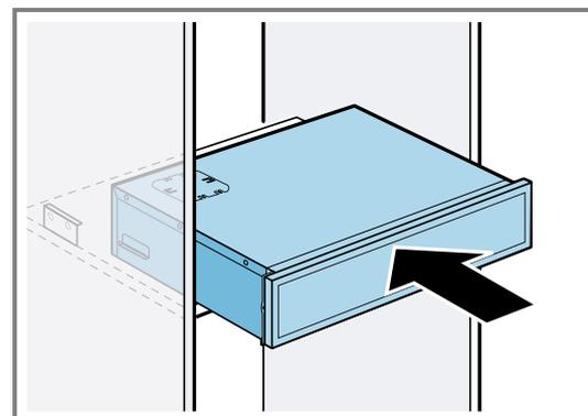
3. Wenn sich das Gerät nicht einschieben lässt, die Kippschutzwinkel in der Höhe verstellen. Dazu die Schrauben lösen und die Kippschutzwinkel nach oben schieben.
