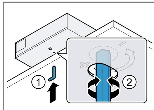
8. Das Gerät in das Möbel schieben, mittig ausrichten und festschrauben.
