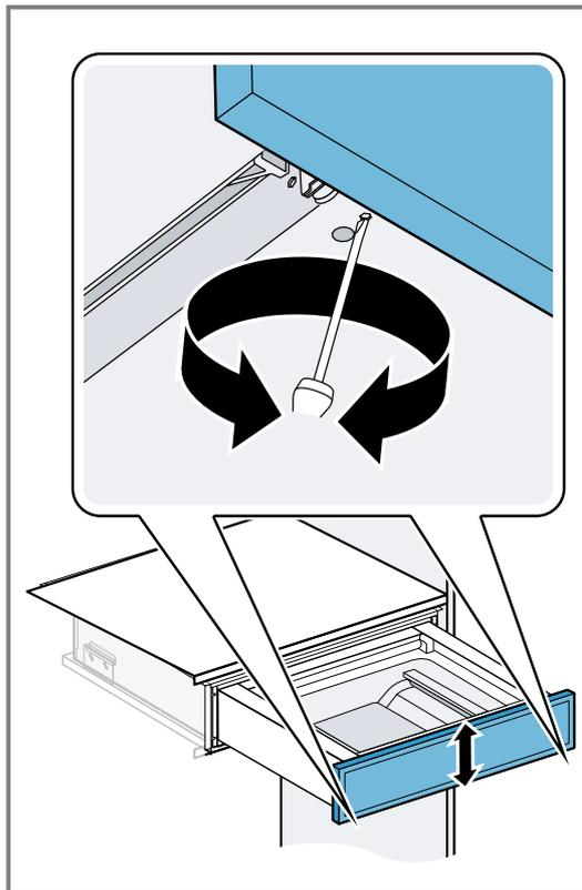
Maximal sind -1,5 bis +1,5 mm Ausrichtung möglich.
