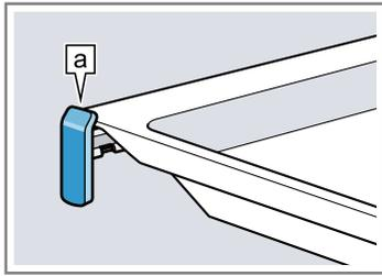
**Remarque :** Lorsqu'ils sont complètement sortis, les rails télescopiques s'enclenchent en place. Repoussez les rails télescopiques dans le compartiment de cuisson en exerçant une légère pression.
