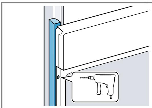
4. Fixez l'appareil avec une vis adéquate.
