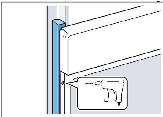
4. Das Gerät mit adäquater Schraube befestigen.
