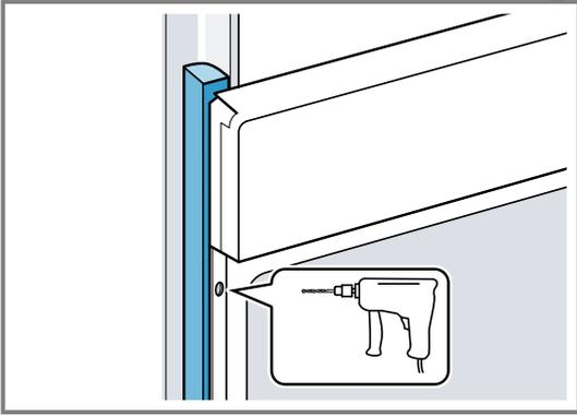
4. Das Gerät mit adäquater Schraube befestigen.
