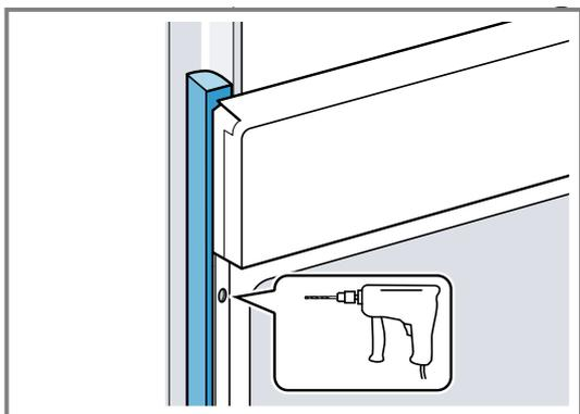
4. Fixez l'appareil avec une vis adéquate.
