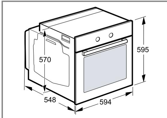
**19.3 Einbau unter einer Arbeitsplatte**
