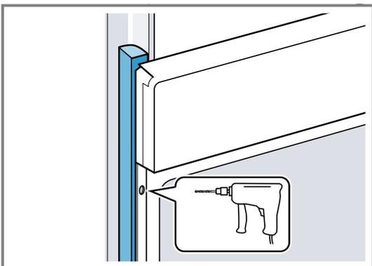
4. Das Gerät mit adäquater Schraube befestigen.
