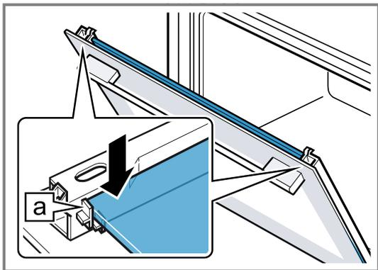
5. Die Gerätetür öffnen und Türdichtung einhängen.
