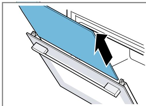
9. Se necessário, retire o friso de condensação para o limpar.
