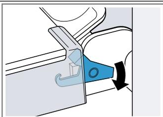
3. Den Sperrhebel am linken und rechten Scharnier zuklappen ②.
