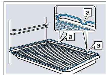
Rost Den Rost mit der offenen Seite zur Gerätetür und der Krümmung
