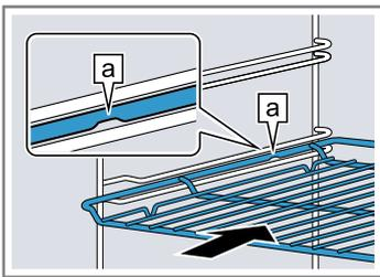
Blech Das Blech mit der Abschrägung
