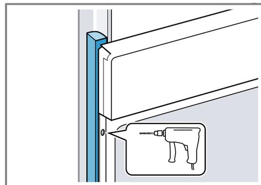
4. Das Gerät mit adäquater Schraube befestigen.
